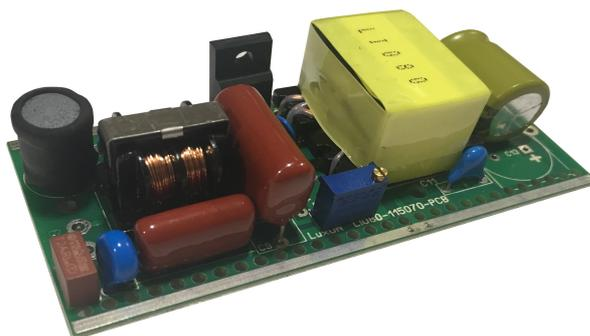
Данный источник питания предназначен к использованию в светильниках средней и высокой мощности на основе светодиодов.
